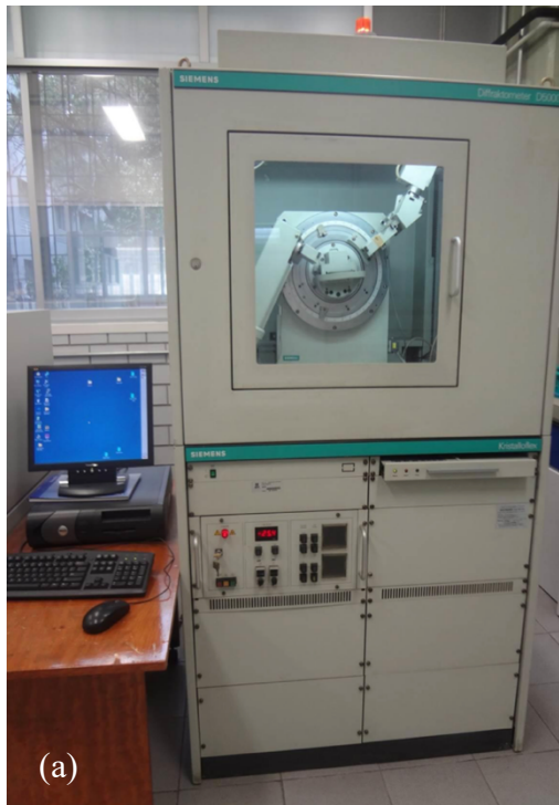
Figura 15. Equipo de DRX. (a) Computadora del equipo y difractómetro Siemens D-5000; (b) Detalle de los componentes del difractómetro de DRX, fotografía del equipo empleado para los estudios realizados en este trabajo en el laboratorio del Instituto de Geología de la UNAM (LANGEM).
