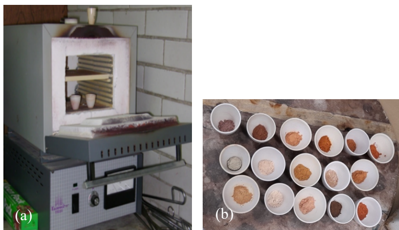
Figura 10. (a) Mufla para calcinar las muestras en crisoles de porcelana hasta 1000 °C; (b) Crisoles de porcelana con muestra.
