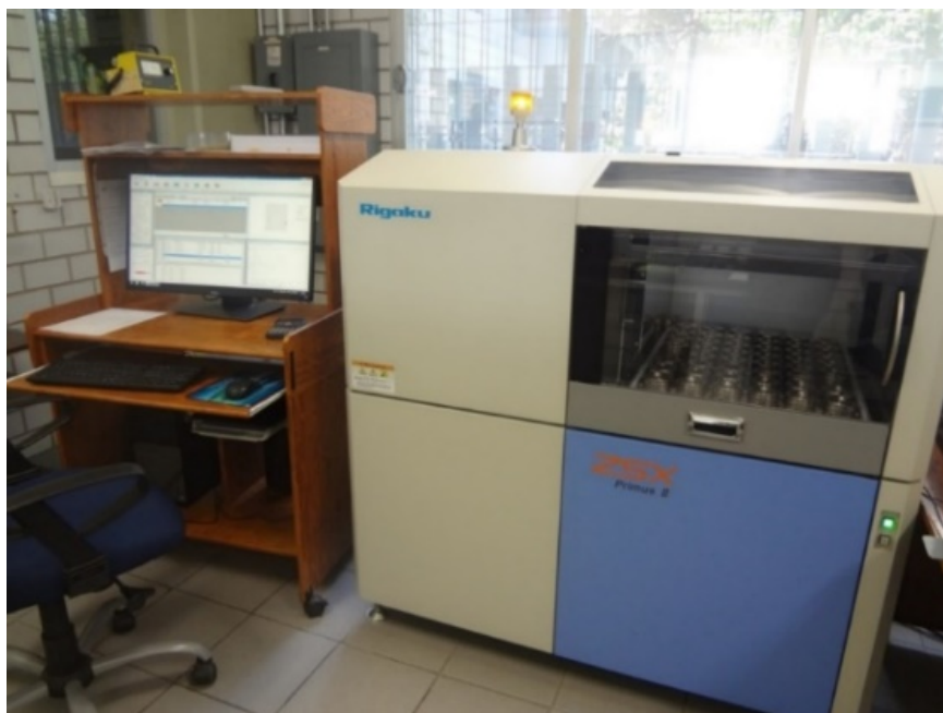
Figura 11. Equipo de FRX. Espectrómetro secuencial RIGAKU ZSX Primus II del laboratorio del Instituto de Geología de la UNAM (LANGEM).
