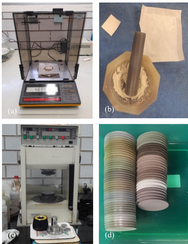
Figura 9. Equipos/procedimientos para la elaboración de tabletas para el análisis de elementos traza. (a) Balanza electrónica para el pesado de la muestra y el material aglutinante; (b) Mortero de ágata para mezcla de muestra y micropolvo; (c) Prensa hidráulica y dado de acero para la preparación de las tabletas; (d) Tabletas terminadas para su análisis.
