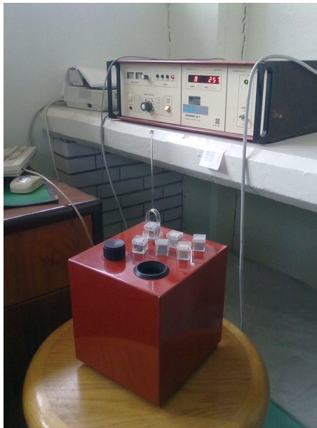
Figura 4.4: Equipo Kappabridge KLY-2 del Instituto de Geofísica con el que se midió la susceptibilidad magnética de las muestras recolectadas en campo
