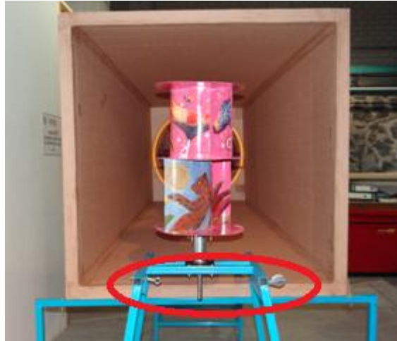
Figura 3.4 - Muestra arreglo de tornillo de ojo, eje y polea por los cuales se sujeta y pasa la cuerda de frenado. (ver figura 3.3)
