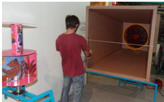
Figura 3.6 - Se muestra la toma de lecturas de velocidades en distintos puntos con un anemómetro de hilo caliente.
