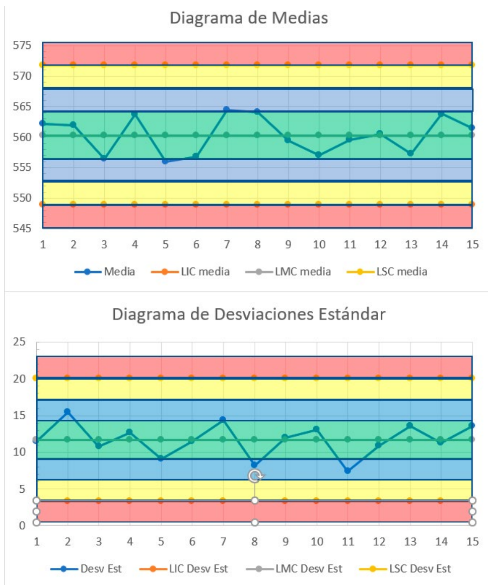
Figura 108. Diagrama de Medias y Desviaciones Estándar usando Excel, con la plantilla arcoíris para interpretar el diagrama x-S.
